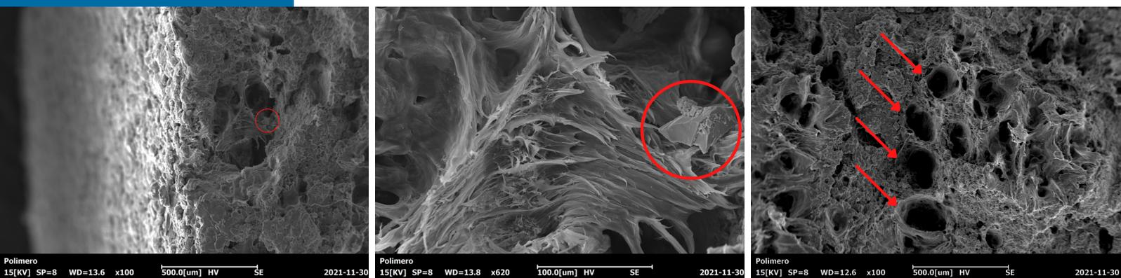
Figg. 9-11 - Osservazione al SEM della superficie di frattura di un provino in PP dopo essere stato sottoposto a prova di trazione.
