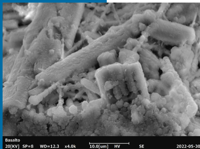
Fig.4-5 – Immagine SEM e spettro EDS su campione di basalto proveniente dalla spiaggia Reynisfjara in Islanda. Risultati espressi in % peso.
